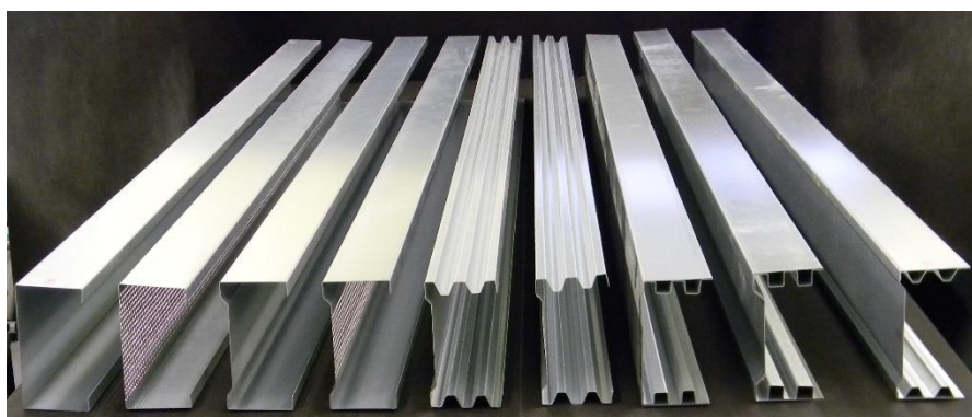
Przykładowe przekroje badanych cienkościennych belek ceowych
